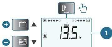
1 Menu "Réglage du seuil d'alarme batterie cellule"
